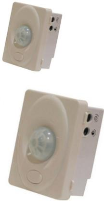
Sensor volumétrico. Cuando el AG-2100BR detecta movimiento este cierra un contacto que deja pasar la luz, cuando deja de detectar movimiento apaga la luz con un pequeño retraso. El sistema tiene ajuste crepuscular y de tiempo.
